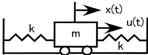
(1)台車の水平方向の変位を $x(t)$ として微分方程式モデルを答えてください。(10点)
