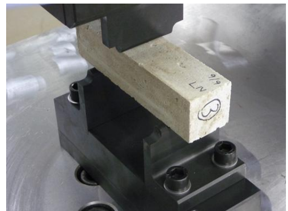
図 2 PCM の曲げ強度試験
