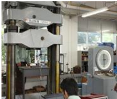
万能試験機での実験
